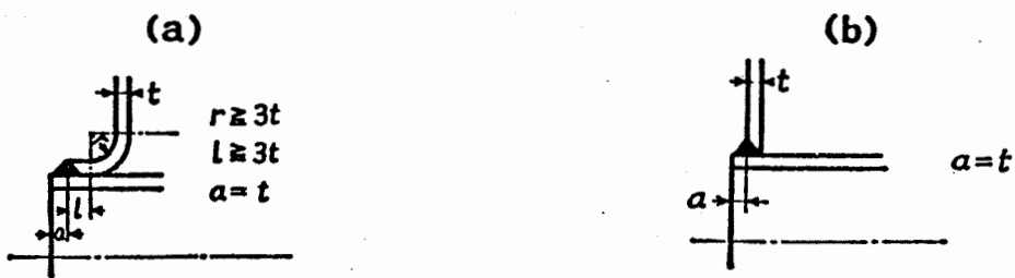
図2.5 炉筒の取付け
