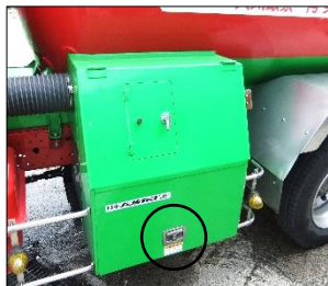
操作箱のロック装置
