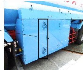
操作箱のロック装置
