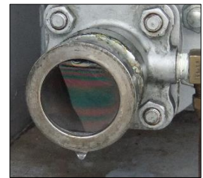
発泡液の膜 (シャボン玉の原理)
