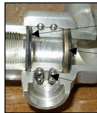
オイルシール(グリスの漏れを止める) パッキン(1枚のパッキンでガスの漏れを止めている。) スチールボール(回転をスムーズにする)
