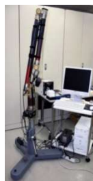
三次元形状測定器による閉止板の形状測定
